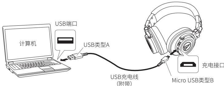
2. 连接附带的USB充电线(USB类型A侧)至计算机, 开始充电。
